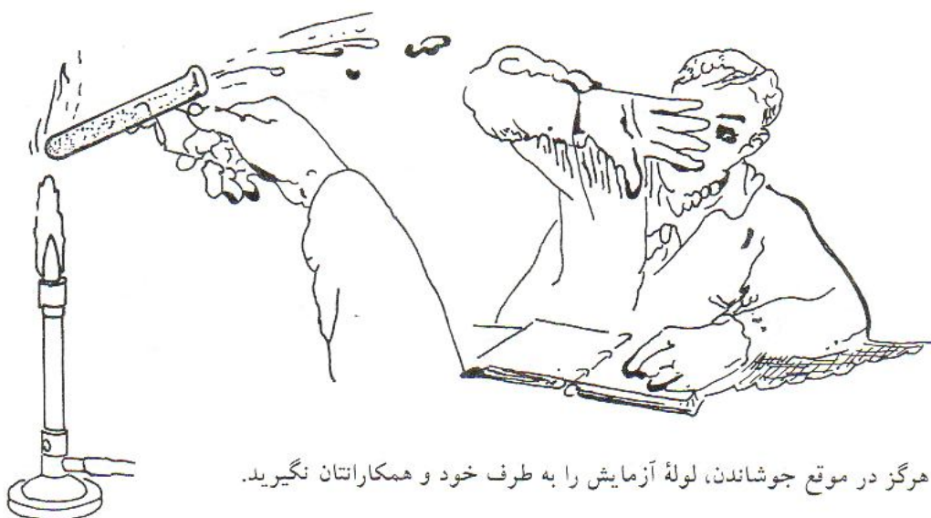
شکل 1- احتیاطهای لازم برای جوشاندن محلولها
